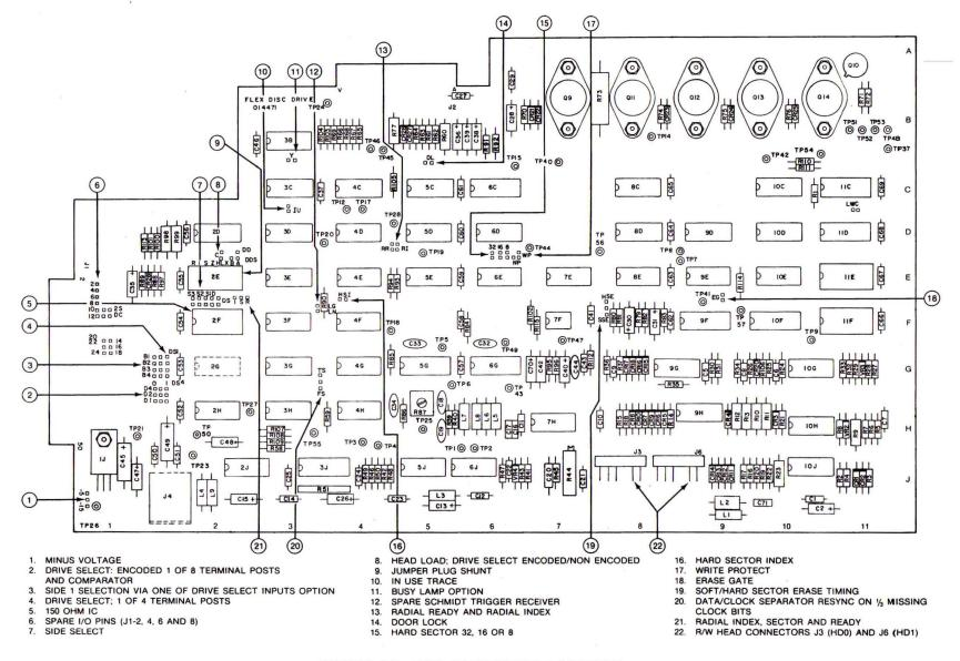
FIGURE 3-5. PCB COMPONENT LOCATION
