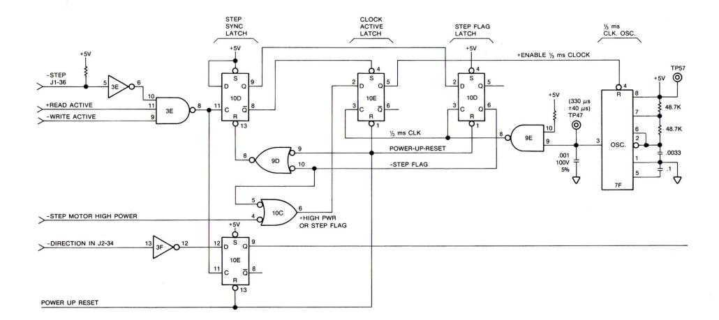
FIGURE 2-4. STEPPER MOTOR CIRCUITRY
