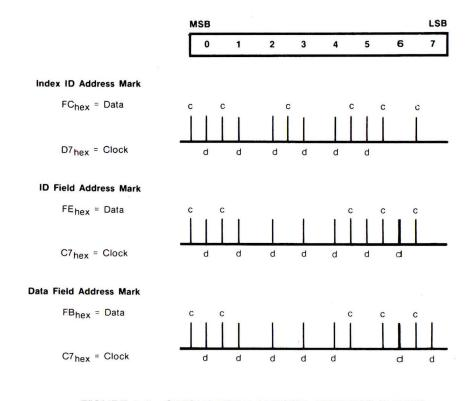
FIGURE 5-6. SINGLE-HEAD UNIQUE ADDRESS MARKS
