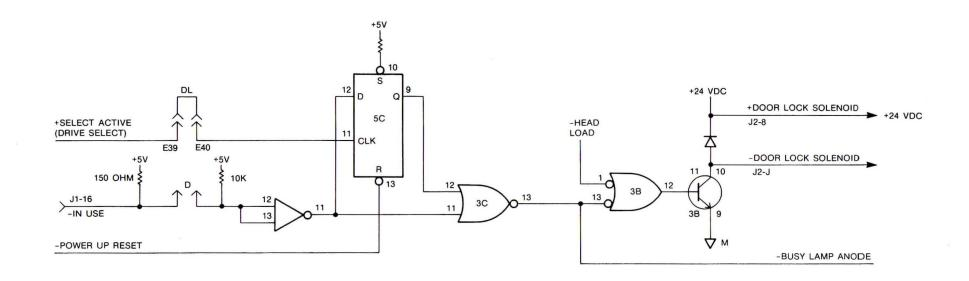
FIGURE 3-15. DOOR LOCK CIRCUIT
